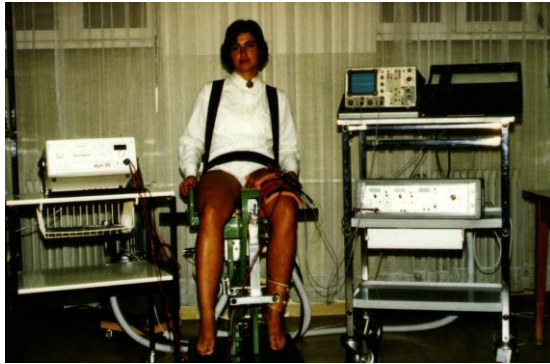
Abb. 1 Kraftmeßstuhl mit Stimulator und Kraftmeßeinheit. Der Proband ist mit Meßelectroden versehen und mit Schulter- und Beckengurt fixiert.
