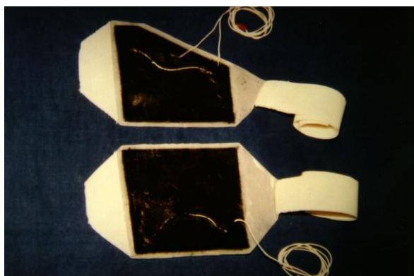
Abb 5. Technische Entwicklung anatomisch geformter Elektroden für die M. quadriceps - Stimulation mit eingebauten Elektrodenanschluß-leitungen zur homogenen Verteilung des elektrischen Feldes.
