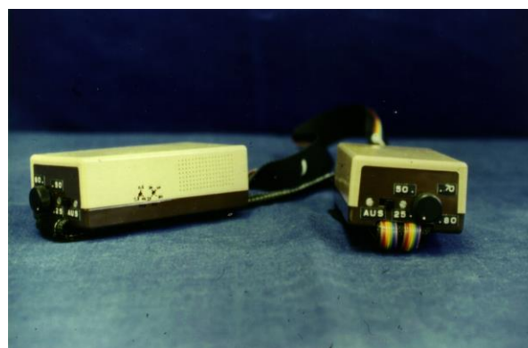
Abb12. Akku-betriebener Stimulator-Gürtel für die Elektrostimulation der Oberschenkel-Muskulatur.
